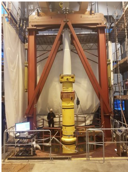
Slik ser teknologien ut, fullt installert og klar for testing. Totalt er utstyret 13 meter høyt og veier 10 tonn. (Foto: Vasshella Flexibles)
